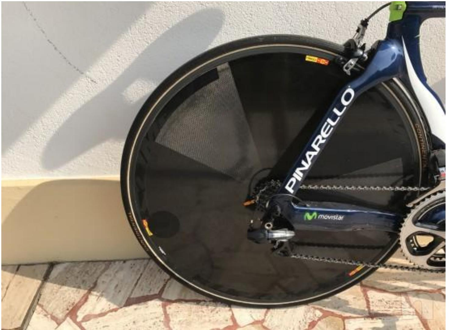
La **ruota lenticolare** è una particolare ruota per bici da corsa in cui non vi sono più i raggi a collegare il mozzo al cerchio, ma un'unica struttura solida, inventata da **Antonio Dal Monte**. Il nome deriva dalla forma del disco in questione, che non è piatto ma appunto a forma di lente. Il profilo è studiato appositamente per avere un'ottima penetrazione aerodinamica.
